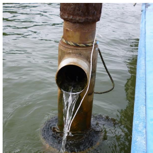
写真2 湧水が流出するパイプ中に計測器をひもで吊るした状態
